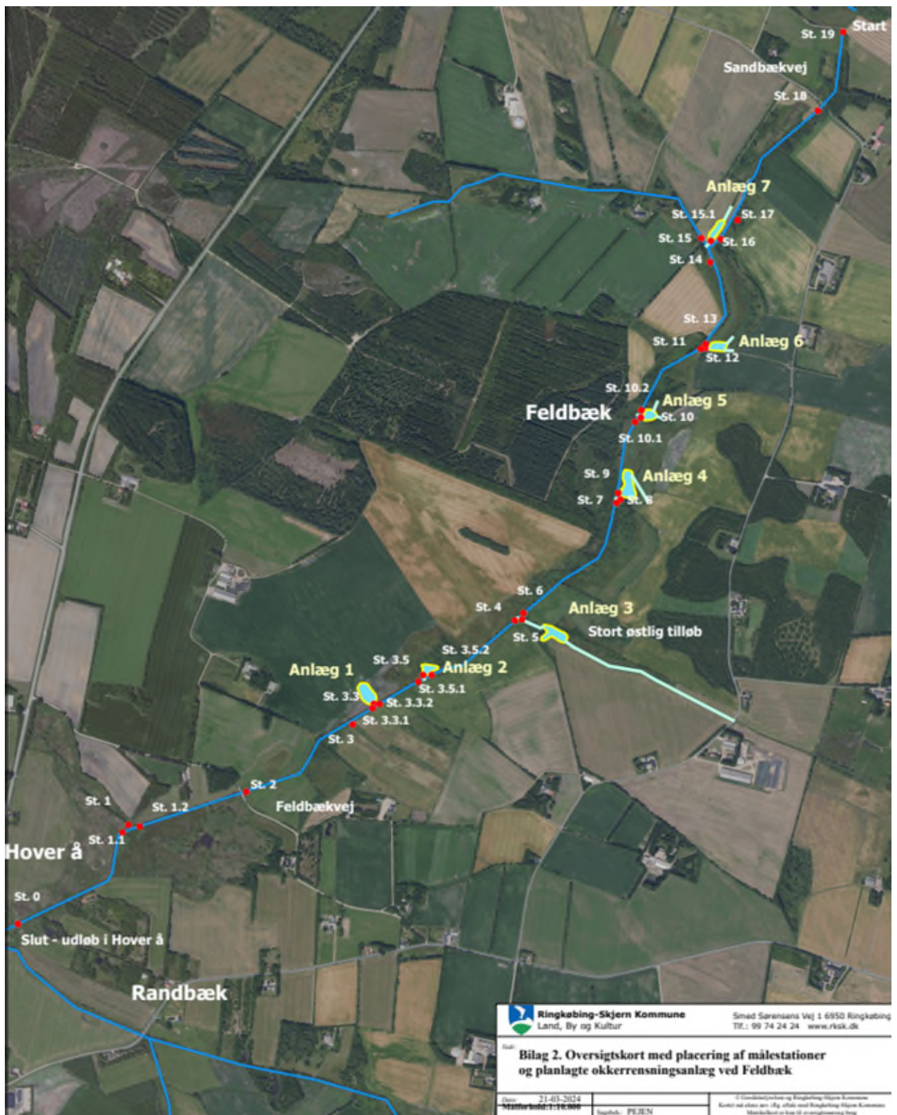
Fig. 11. Oversigtskort med placering af målestationer for de berørte del-strækninger ved Feldbæk-systemet
