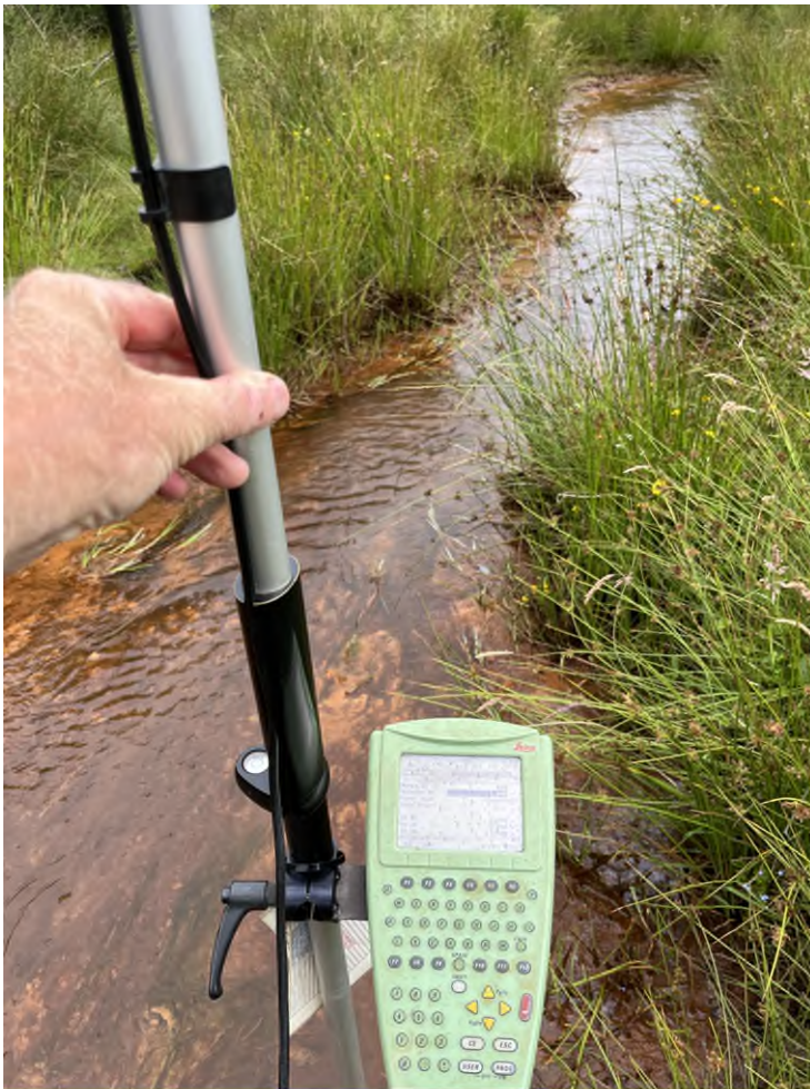
Figur 13. Foto der viser opmåling af projektområderne med GPS- opmålingsudstyr
