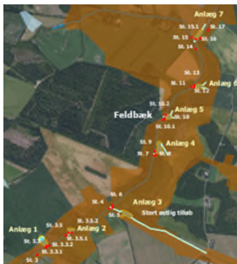
Figur 9. Lavbundsarealer med okker omkring de udpegede projektområder 1-7. – Områderne der er registreret med brun farve, svarer til okkerklasse 2, dvs. svarende til middel risiko for okkerudledninger.
